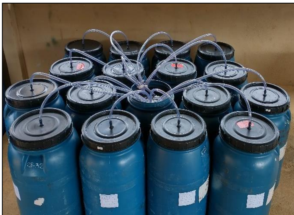
Figura 4 – Instalação do processo de fermentação
